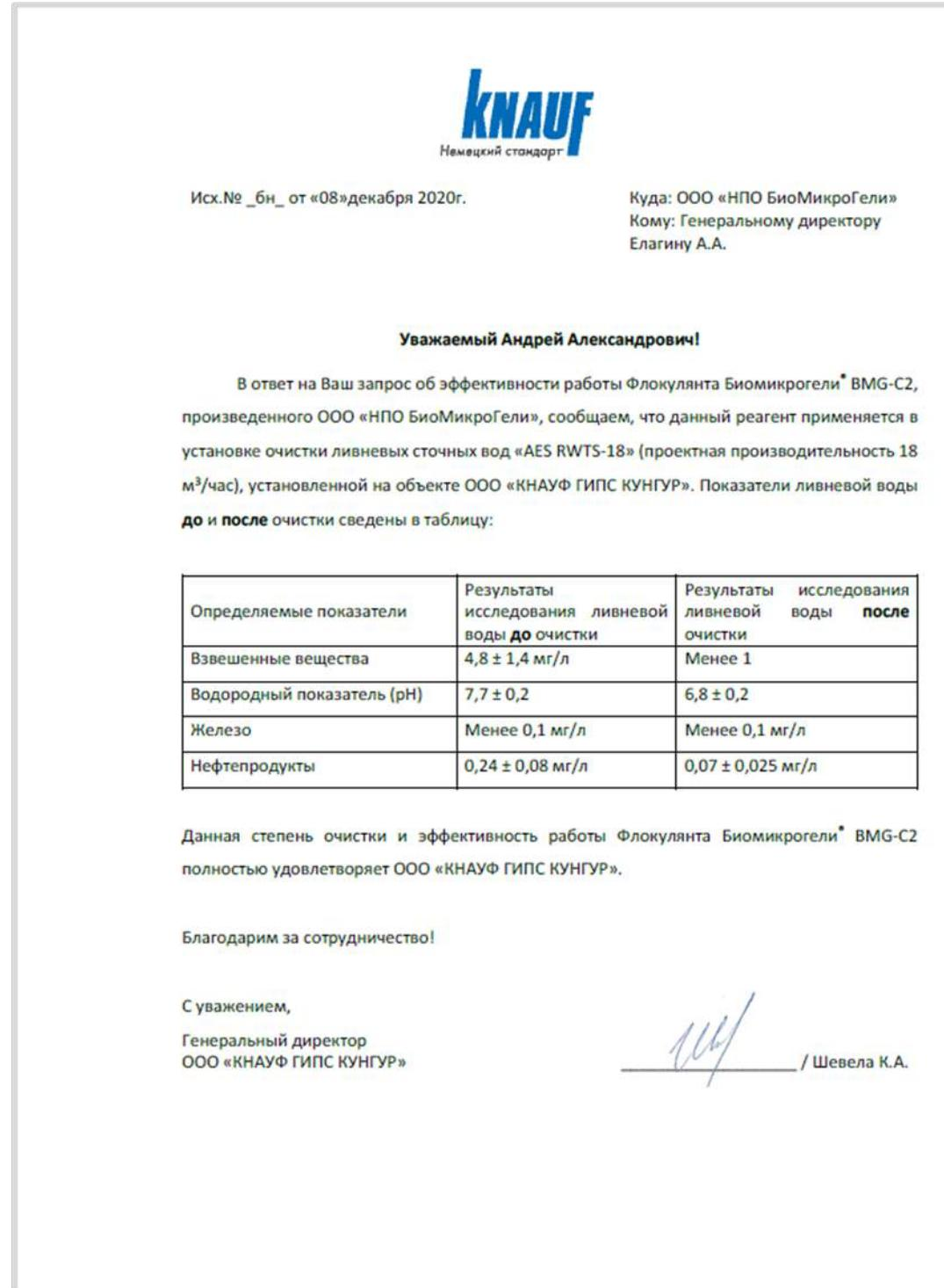
**KNAUF. Очистка сточных вод от нефтепродуктов. Достигнуты целевые показатели качества воды с использованием флокулянта БиомикроГели® BMG-C2.**
